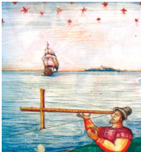
FIG. 1 – L'arbalétrille, ou bâton de Jacob (gravure de Johannes Van Keulen, 1760), était utilisée pour obtenir la latitude d'une position sur la mer.
