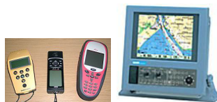
FIG. 4 – À gauche : des (récepteurs) GPS de poche ; à droite : un GPS de bateau qui permet de déterminer et contrôler automatiquement des trajectoires.
